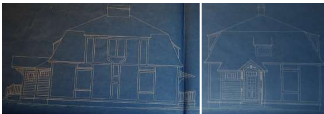
B 53: Fasadritning norra och östra fasaden, 1922. Till höger i den vänstra bilden skimtar skärmtaket och den västra förstukvisten som aldrig byggdes in. Ritning: 27.
