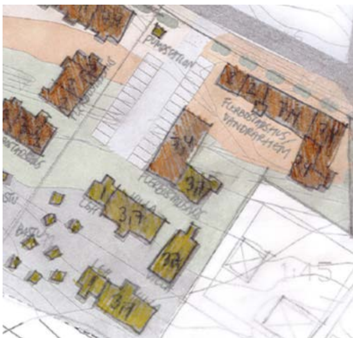
Bild 50 Vid Lapportsvägen kan man placera flerbostadshus eller t ex vandrarhem. Byggnaden blockerar bort järnvägsbuller från uteplatsen. Parkeringar är placerat mot höjdkurvorna. I stället av en större parkeringsplats kan man dela det till två mindre platser. Lapportsvägen är viktigt att mötas med byggnadsmassor av bullerskäl. Att minimera parkeringsytan vid Lapportsvägen har stor påverka till attraktivitet av området.
