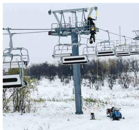
Räddningsaktionen kan börja. Säkringsmannen säkrar räddaren som firas vidare längs vajern fram till liftstolen.
