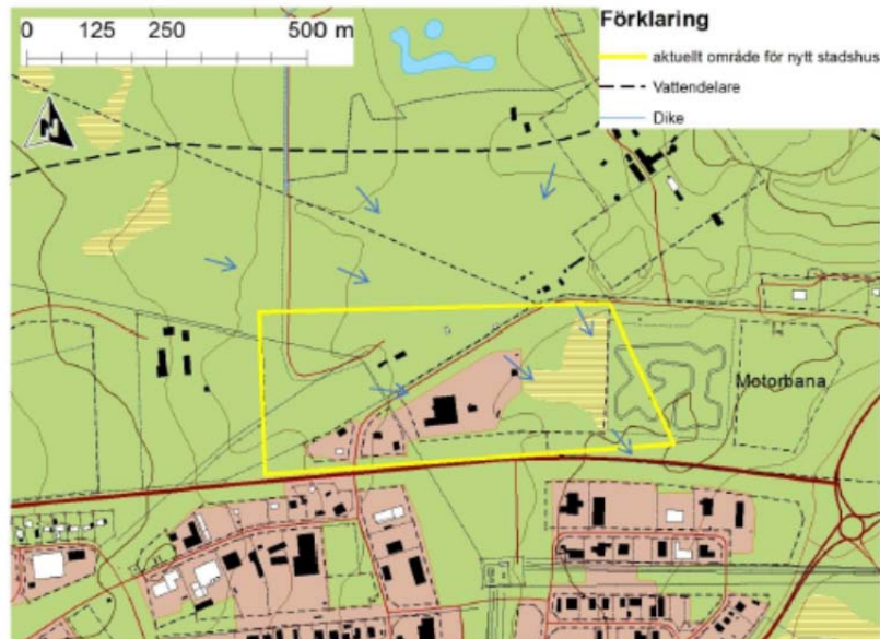
Figur 1 Översiktlig beskrivning av riktning för grundvattenflödet (blå pilar) samt vattendelaren i norr (svart streckad linje). Den gula linjen visar avgränsningen för området där placering av Kiruna nya stadshus utreds.
