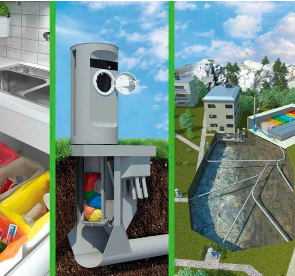
Olika sopor i olika påsar. Sopsugen transporterar påsar med olika typer av sorterat avfall till en avfallsterminal där det tas omhand i en optisk sorteringsprocess. Illustration:Envac
