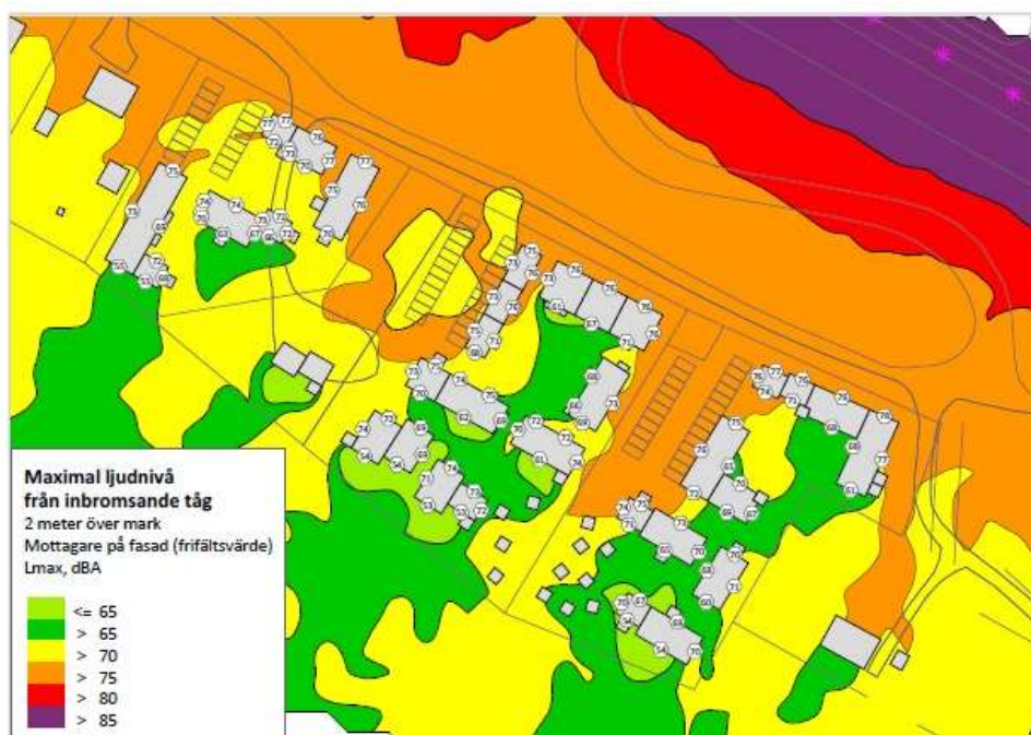
Bild 20 Max.ljudnivå från inbromsande malmåtg, utbredning 2 meter över marknivå samt vid bostadsfasad. (Bullerutredning, järnvägen, 2019. ÅF Consult AB)
