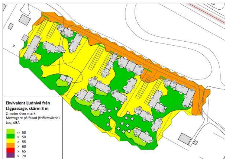
Bild 58 Ekvivalent ljudnivå från passerande trafik, utbredning 2 meter över marknivå samt vid bostadsfasad. Prognosår 2040. Beräknat med 3 m höga skärmar markerade i grönt.
