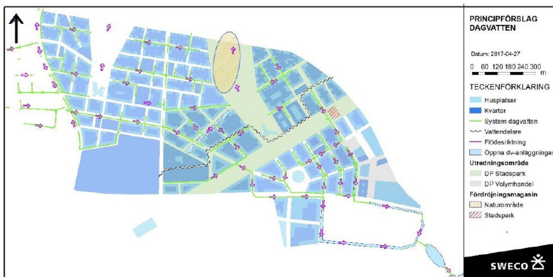
Figur 14 Skiss av föreslaget dagvattensystem i nya Kiruna centrum. Källa: Sweco
