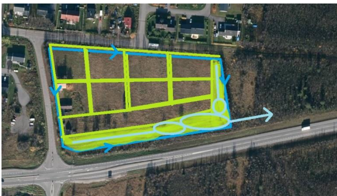
Figur 57. Dagvattenhantering norr om E10. Grön färg visar de ytor som ska lämnas som infiltrationsytor. Skissen utgår från att det bildas 8 villatomter i området.
