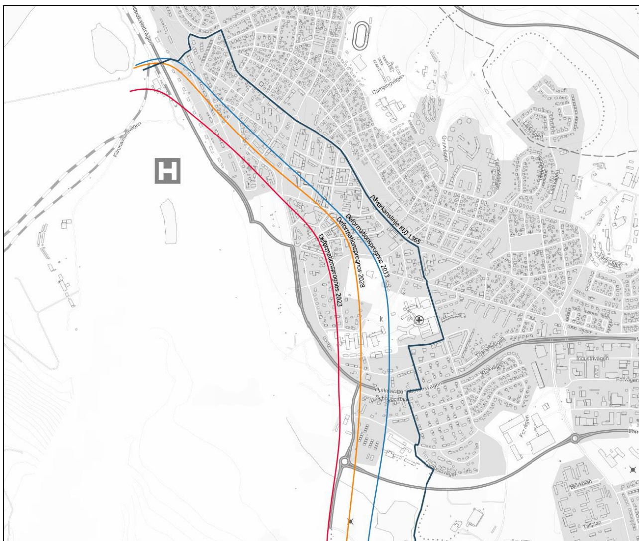
Figur 1. Deformationsprognoser som visar ungefärligt påverkansår. Marken i området mellan gruvan och staden övergår till industrimark i takt med deformationerna. Källa: LKAB.
