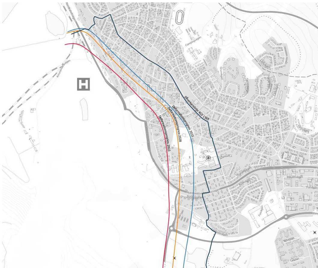
Figur 34. Deformationsprognos med påverkanslinje från gruvbrytning på huvudnivå KUJ 1365 (Kiruna under jord 1365m), (LKAB).
