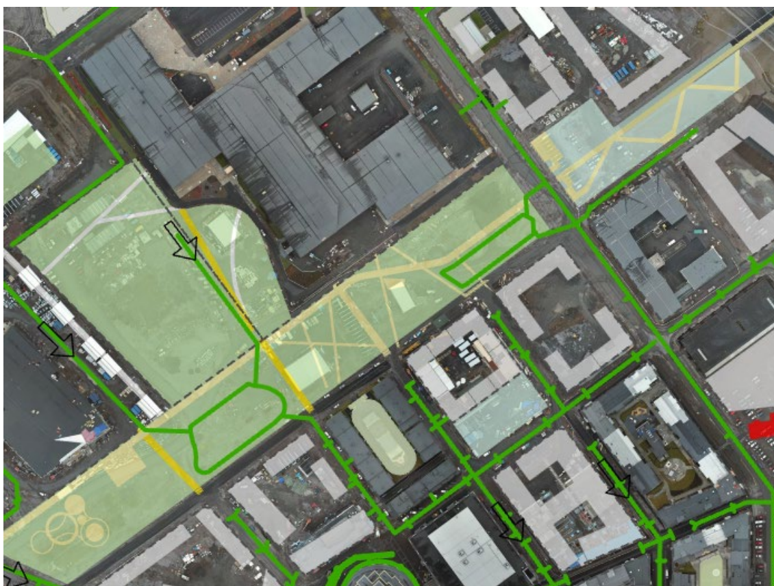
Figur 15, dagvattensystemet vid Stadsparken. Gröna linjer illustrerar magasin och ledningar.
