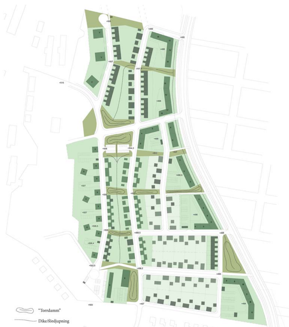
Illustration av föreslagen dagvattenplan, med torrdammar och diken utmärkta i svart streckad linje.
