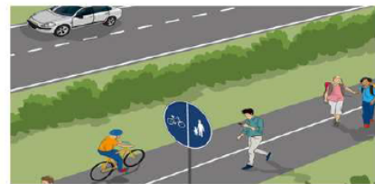
Separerad gång- och cykelbana skild från väg
