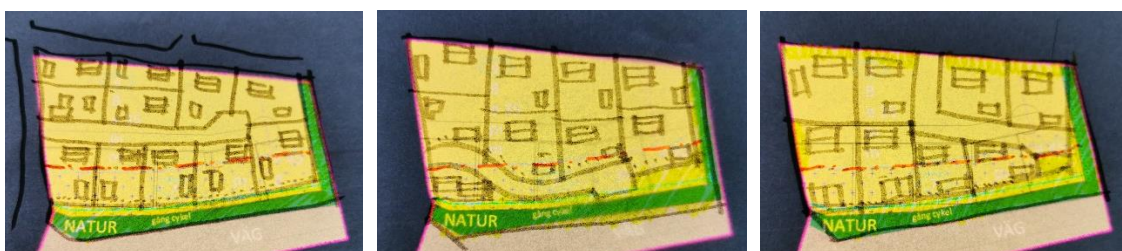
Figur 41–43. Tre olika förslag för hur angöring till fastigheter kan anordnas. Efter samrådsskedet har gemensamhetsanläggning lagts till även i norra delen av bostadskvarteret.
