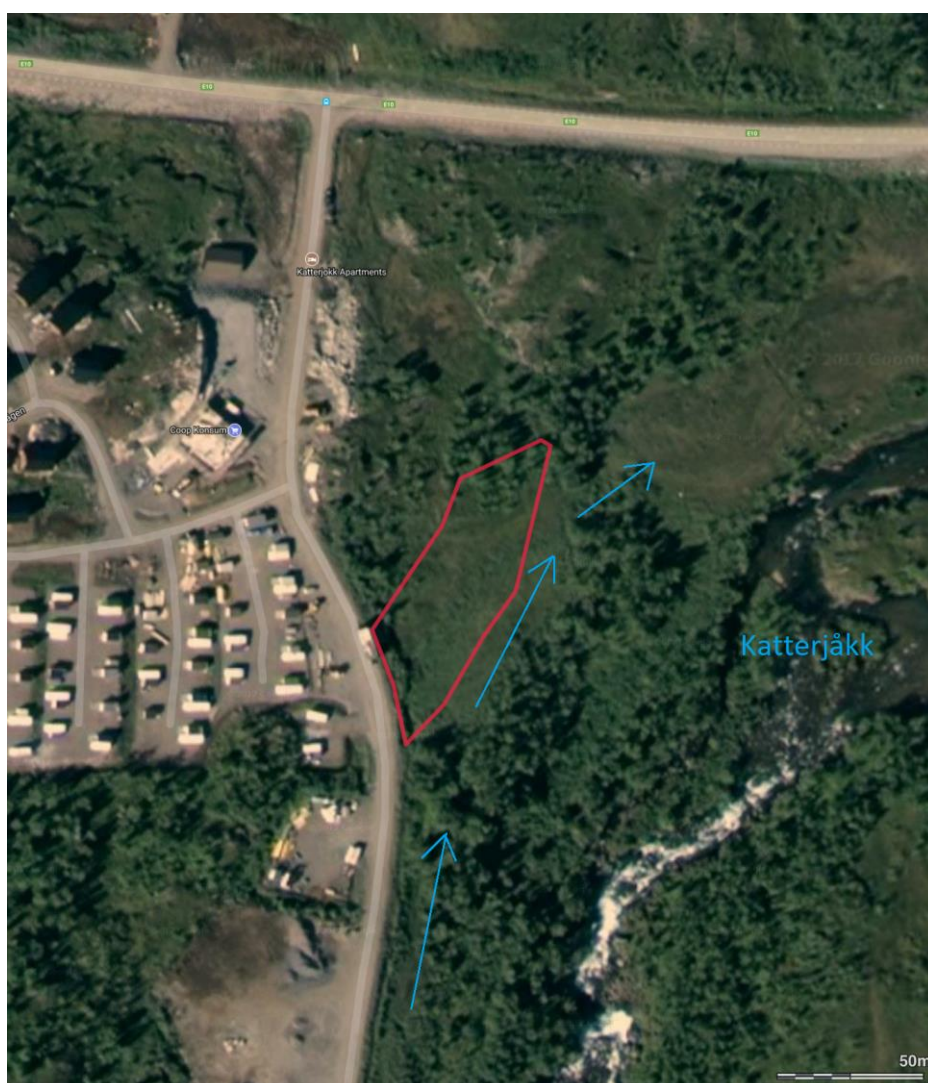
Figur 2. Avgränsning med röd linje för parkeringsytan i den västra delen av myren. Strömningsriktning för grundvattnet i området med blå pilar.
