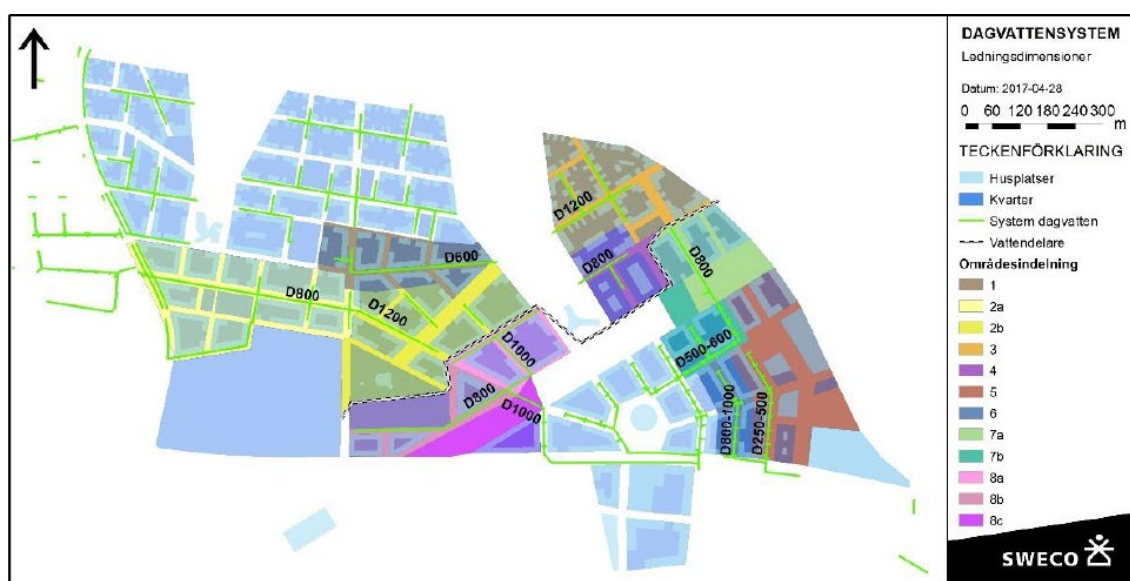
Figur 70. Ledningsdimensioner. Källa: Sweco
