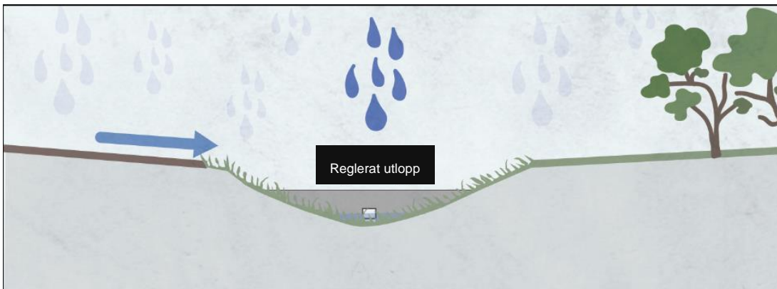
Figur 12. Illustrationsbild för funktion hos torrdamm/infiltrationsstråk med reglerat utlopp (Bilder: Sweco)
