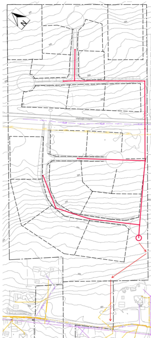
Figur 8. Föreslagen lösning med en gemensamhetsanläggning för hela planområdet. Ett minireningsverk anläggs i södra hörnet (röd cirkel). Föreslagen draging av
