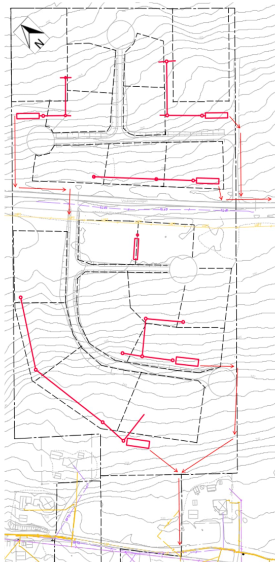
Figur 10. Föreslagen lösning med flera mindre gemensamhetsanläggningar (röda rektanglar). Föreslagen dragning av avloppsledning är visad med röda streck och släpp av rena vatten är visad med röda pilar.
