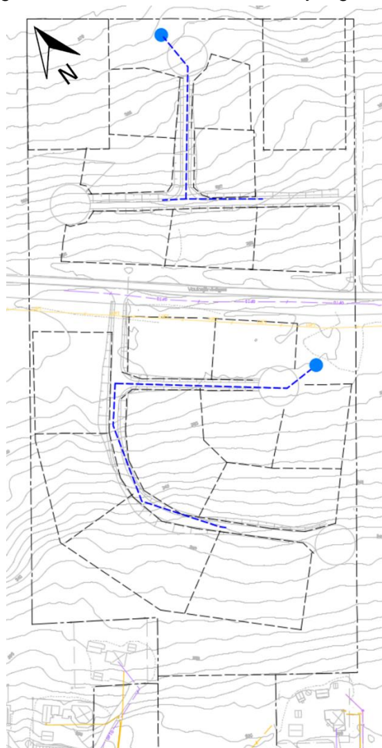
Figur 6. Vattenförsörjning bestående av en uttagsbrunn (blå cirkel) i det norra delområdet och en i det södra. Förslag på dragning av vattenledningar är markerat i streckat blått. Det uppmärksammas att tomtindelningen endast är en illustration.
