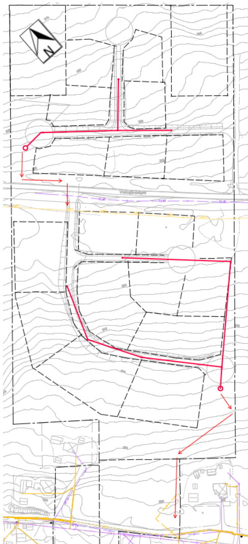
Figur 9. Föreslagen lösning med två gemensamhetsanläggningar Föreslagen dragning av avloppsledningar är visad med röda streck och släpp av rena vatten är visad med röda pilar.
