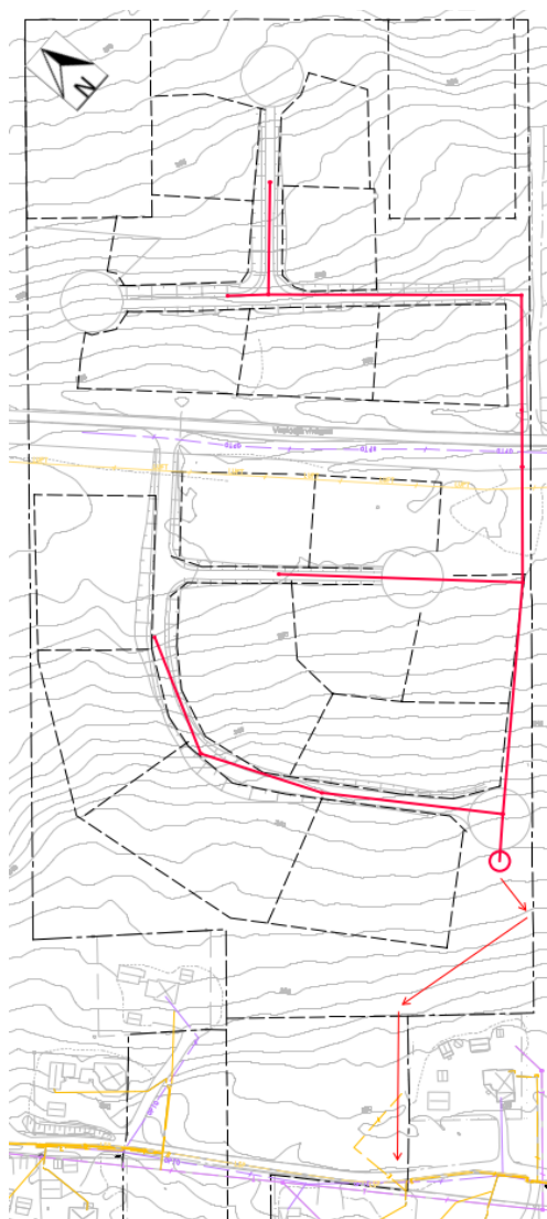
Figur 8. Föreslagen lösning med en gemensamhetsanläggning för hela planområdet. Ett minireningsverk anläggs i södra hörnet (röd cirkel). Föreslagen dragnings av avloppsledningar är visad med röda streck och släpp av renat vatten är visad med röda pilar.
