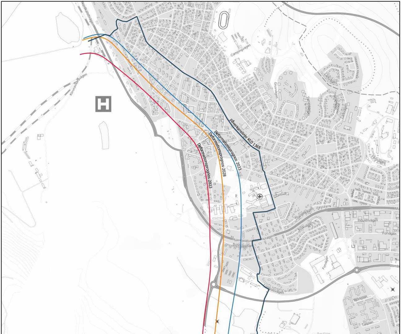
Figur 1. Deformationsprognoser som visar ungefärligt påverkansår. Marken i området mellan gruvan och staden övergår till industrimark i takt med deformationerna. Källa: LKAB.
