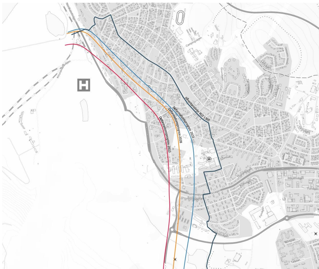
Figur 37. Deformationsprognos med påverkanslinje från gruvbrytning på huvudnivå KUJ 1365 (Kiruna under jord 1365m), (LKAB).
