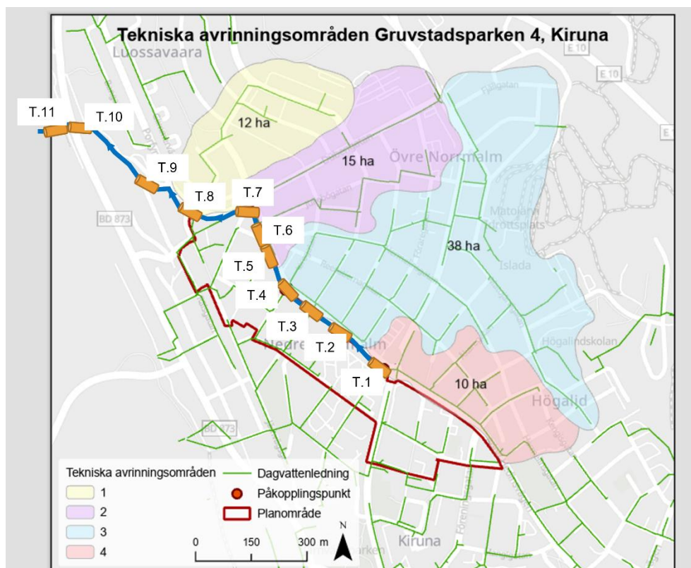
Figur 11. Avledning av påtryckande dagvatten mot Luossajärvi. Planerat svackdike visas i blått och lägen där trummor kommer att behövas visas i orange.
