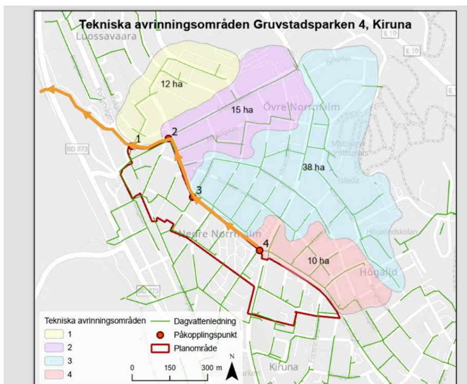
Figur 4. Befintligt dagvattensystem och tillhörande tekniska avrinningsområden. Planerad framtida ytlig avrinning visas med orange pilar.
