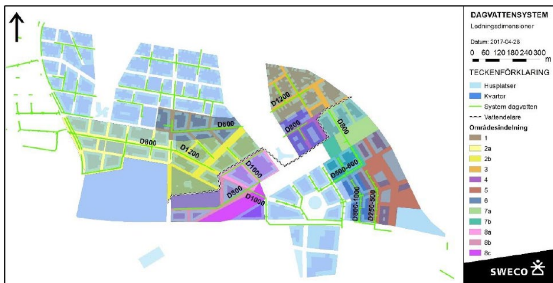
Figur 59. Ledningsdimensioner. Källa: Sweco
