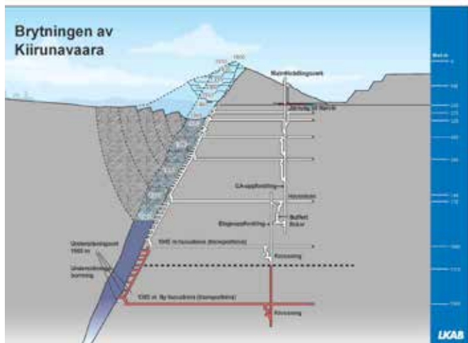
Figur 1.1.1 Princip för grubvrytningen i Kiruna. Illustration LKAB.
